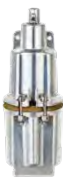
168 zł Pompa zatapialna do wody brudnej Opp 5059340250359 moc znamionowa 400 W max wydajność 9000 l/h wys. podnoszenia 5 m
